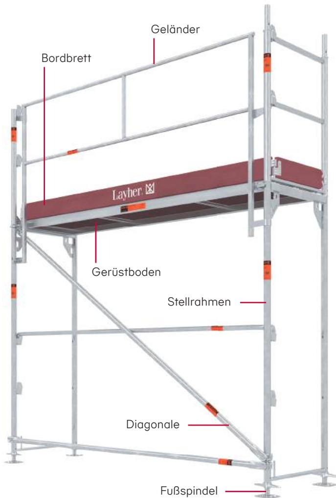
Mit nur **sechs Grundelementen** und wenigen Handgriffen ist dieses Gerüst in logisch-sicherer Aufbaufolge schnellstens – weil schraubenlos – montiert. **Zahlreiche Ausbauteile** ermöglichen eine optimale Anpassung an vorhandene Gebäudegeometrien – ohne großen Mehraufwand in der Montage. Für jeden Einsatz ist das Blitz Gerüst in verschiedenen Gerüstbreiten aus feuerverzinktem Stahl oder leichtem Aluminium lieferbar.
